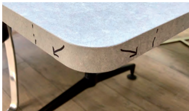
▲ De vervormde folie vanuit de hoek naar de vlakker gelegen gedeelten uitrakelen.
