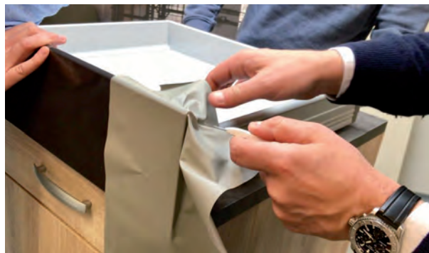
▲ Dit complex gevormd ladekastdeurtje vergt veel vaardigheid in de afwerking.
